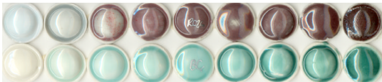
Photo 34: Addition de 8 % de bouillie bordelaise à l'eutectique baryum
