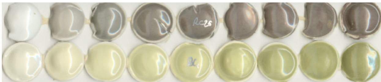
Photo 37 : Addition de 8 % de bouillie bordelaise à Mg2 ( magnésium / alcalins)
